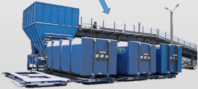
Чиқиндиларни қайта юклаш станцияси
